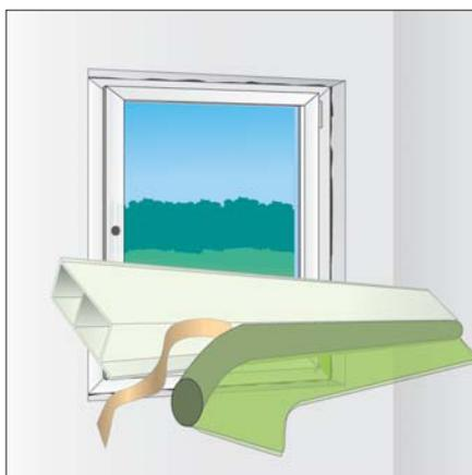
рис.3. Укрепление самоклеящейся полосы ленты illbruck illmod i на планке - профиле.
