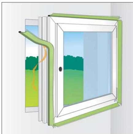
рис.1. Укрепление самоклеящейся полосы ленты illbruck illmod i на раме.
