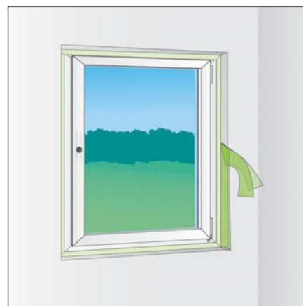
рис.4. После крепления планки с камерой на раме активировать illbruck illmod i посредством отрыва выступающей части пленки.
