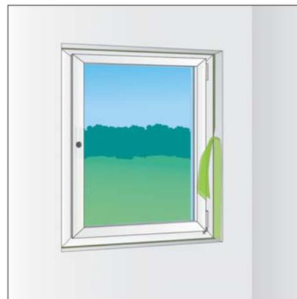
рис.2. После монтажа при отрыве выступающей части пленки сжатая лента активируется внутри пленочной оболочки.
