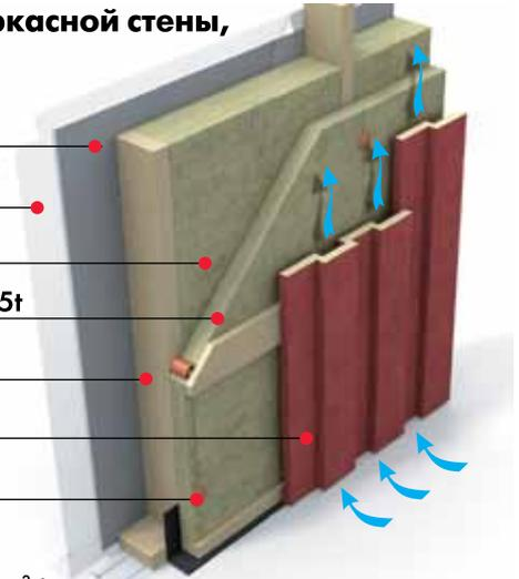
**Типы стен по степени вентилирования**
