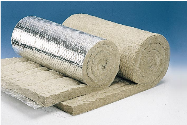
PAROC Wired Mat 100, PAROC Wired Mat 100 AL1 (старое название PAROC 100 VM и PAROC 100 AVM) Прошивной мат из каменной ваты (Wired Mat 100) Прошивной мат из каменной ваты, покрытый алюминиевой фольгой 0,04 мм (Wired Mat 100 AL1) Негорючий изоляционный материал
