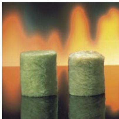
Слева образец каменной ваты до испытания на негорючесть, справа – после испытания.
