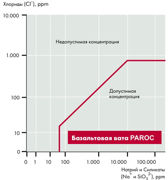
Рис 3. Состав вымываемых водой ионов, ASTM C 795
