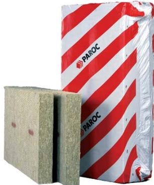
Одна из поверхностей каждой плиты имеет маркировку в виде пятен красного цвета. Изделие следует монтировать маркировкой вовнутрь
