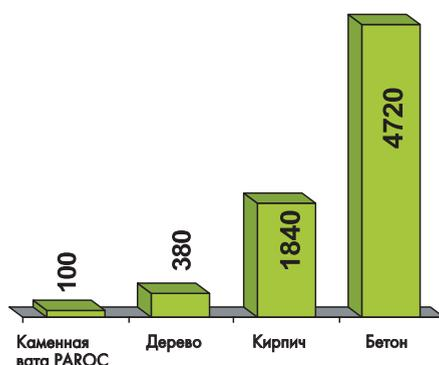
На диаграмме представлены толщины различных строительных материалов (мм), при которых они имеют одинаковые теплоизолирующие свойства в сравнении со слоем каменной ваты PAROC толщиной 100 мм
