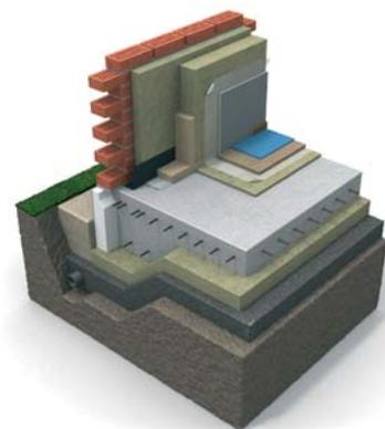
Конструкция «плавающего» пола
